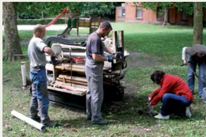
Afbeelding 5.11 : Nemen van een bodemonster in het kader van het Pollusal-project in samenwerking met SPAQuE en de Universit  Catholique de Louvain. Om hun compatibiliteit te garanderen worden bij de extractie van de kern die als monster voor chemische bodemanalyses zal dienen rond het geboorde gat in het bos ook andere monsters voor magnetische analyse genomen.
