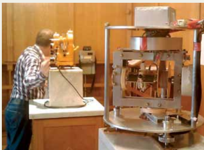
Afbeelding 5.7: Vooraan de automatische Diflux theodoliet AUTODIF MKII. Op de achtergrond een waarnemer die een manuele meting uitvoert met een ZEISS010 Diflux. De AUTODIF zal de manuele theodoliet in de automatische Observatoria vervangen.
