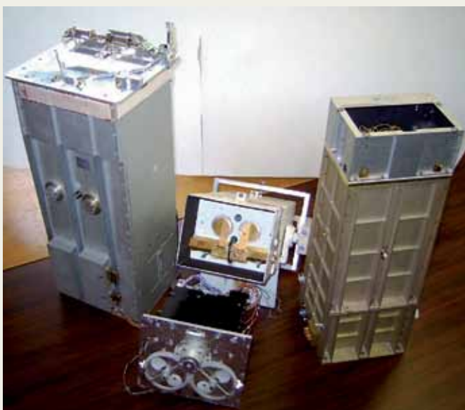
Afbeelding 2.3: Enkele van de instrumenten voor de meting van de zonne-irradiantie uit het rijke verleden van het KMI. Links: SOVA-instrument, dat door het ruimteveer na een vlucht van 8 maanden op de Eureka-satelliet uit de ruimte werd teruggebracht. Midden achter: CR3-instrument, dat deel uitmaakte van de Wereld Referentie Groep voor metingen vanaf de grond. Het gelijkaardig instrument CR2 maakt nog steeds deel uit van deze Wereld Referentie Groep. Midden voor: Diarad/Sovim-instrument, dat in 2008 werd gelanceerd en zich nu op het Internationale Ruimtestation ISS bevindt. Rechts: ons eerste ruimte-instrument Solcon-1, dat in 1983 op Spacelab vloog.
