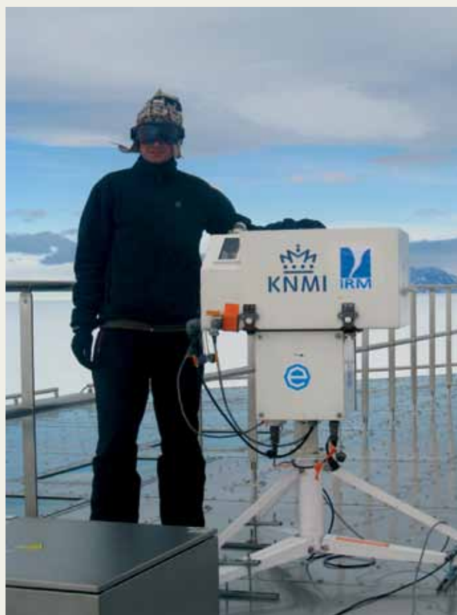
Abbeelding 3.6: KMI-medewerker A. Mangold op het dak van het Princess Elisabeth station met de Brewer ozonspectrofotometer. Het instrument is een donatie van onze Nederlandse collega's van het Koninklijk Nederlands Meteorologisch Instituut.
